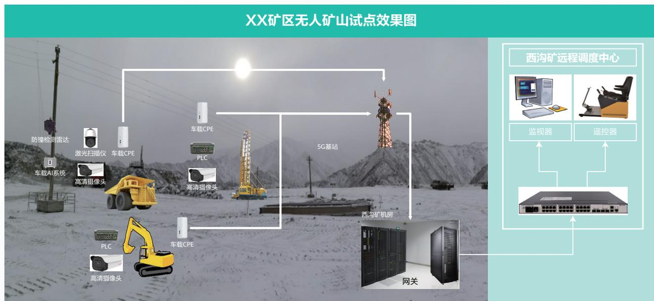
依靠于5G网络的低延时特性，实现了内蒙古某高原矿区的矿卡和挖掘机等大型机械设备的远程驾驶。驾驶员能够在山下办公室里，通过操作台和显示屏对山上的设备进行远程无延迟的操控，大大降低了高原矿山恶劣的环境给驾驶员健康和安全的隐患。
